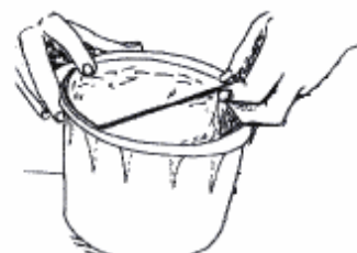
alten O-Ring entfernen
