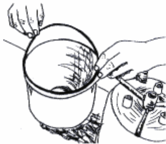
neuen O-Ring einsetzen
