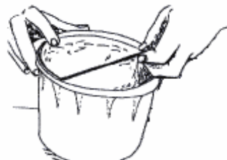
alten O-Ring entfernen
