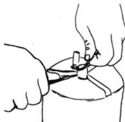
alte O-Ringe oben und un- ten (Stützfuß) am Dampf- zylinder entfernen
