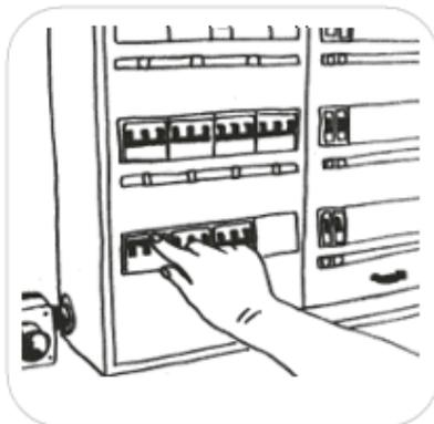
Gerät spannungsfrei schalten und gegen Wiedereinschalten sichern
