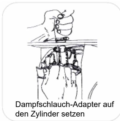
Dampfschlauch-Adapter auf den Zylinder setzen
