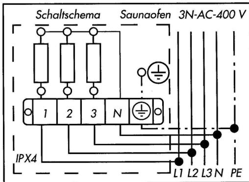
Der Anschlußplan für die Raumheizung des Saunaofens ist auf der Innenseite der Anschlußkastenabdeckung angebracht und entspricht nebenstehender Abbildung.
