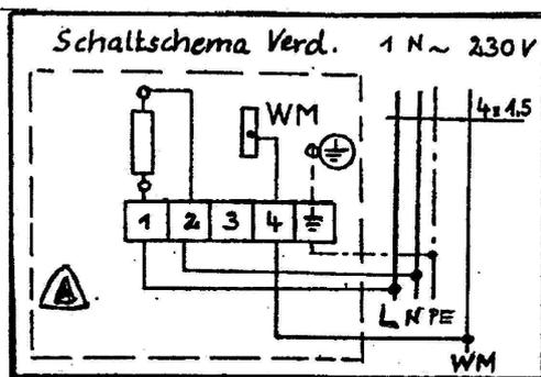
Der Anschluß für den Verdampfer des Saunaofens entspricht nebenstehender Abbildung.
