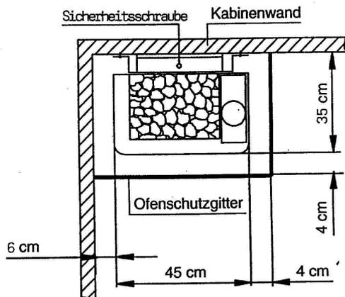
Der Saunaofen ist über der Zuluftöffnung an der Wand zu befestigen. Hierzu die Wandaufhängung des Saunaofens über der Mitte der Zuluftöffnung mittels 2 Schrauben befestigen. (Lt. Nebenstehender Abb.) Den Saunaofen danach in die Wandaufhängung einhängen, und mittels der Sicherungsschraube an der Wandaufhängung befestigen.
