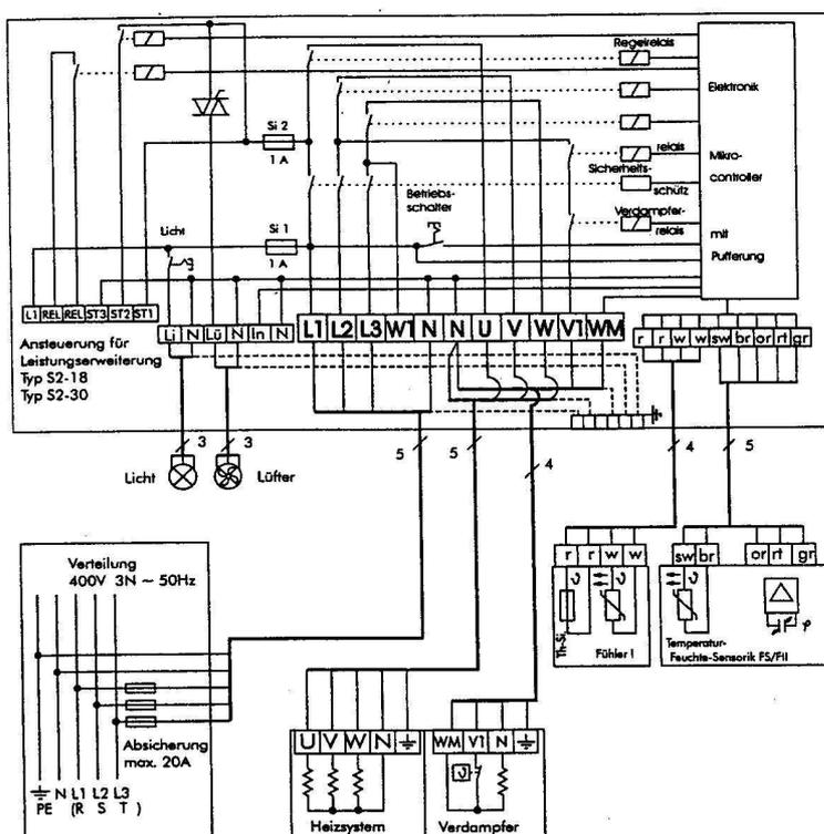
Wird die Anlage mit einem Steuergerät ohne Wassermangel-Schaltung betrieben, bleibt die Klemme „WM“ im Steuergerät unbelegt !
